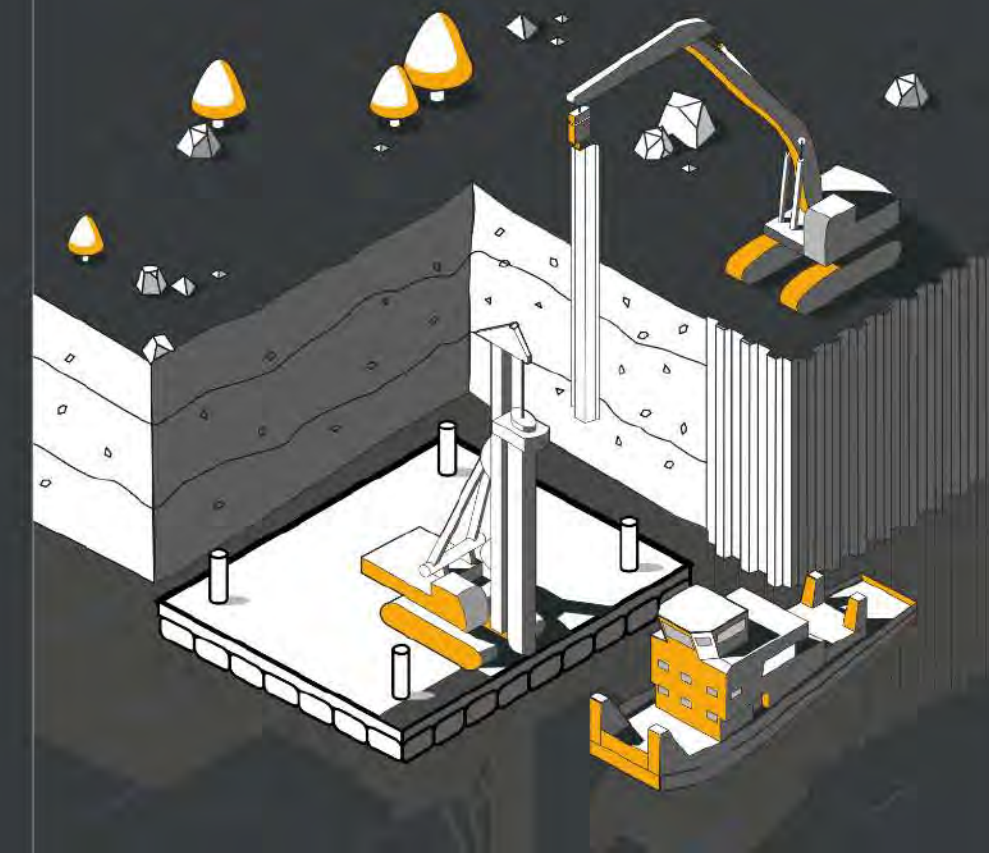
04 Шпунтовые ограждения берегоукрепление
